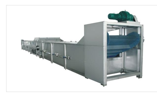
本机是消化吸收德国技术同类产品的基础上,全新设计的,专门 应用于乳品,饮料,果冻的二次杀菌,整机符合包装产品接触部分 全部采用SUS304不锈钢制作,大链板。链轮也采用同种原料, 具有抗酸碱,耐腐蚀的作用,水箱由蒸汽加热,蒸汽用量由蒸汽电 磁阀自动控制, 热水可充分利用, 整机设计合理, 制造精良, 运 做稳定,美观大方。
