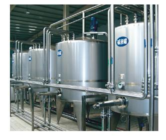
清洗液的加热为自动加热方式,通过温度控制仪设定清洗温度,控 制蒸汽调节阀的开启量来限制蒸汽的量从而使清洗液维持在所需的 温度; CIP站各罐内液位的高低采用自动报警并指示; 当清洗液的 浓度降低时,通过人工补加浓酸浓碱;清洗过程转换通过人工操作 相应的管路阀门进行;罐内缺水时进行人工补水;
